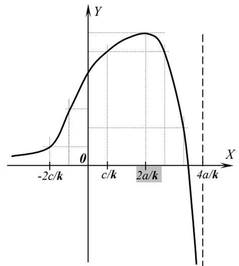
Рис.1б. Перемасштабирование оси  $OX$  при построении графика  $y = f(kx)$ .
