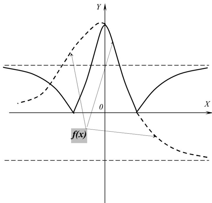
Рис.17а. Построение графика функции  $|f(x)|$  по функции  $f(x)$  из рис.16 а. Рис.17б. Построение графика функции  $|f(x)|$  по функции  $f(x)$  из рис. 16б.
