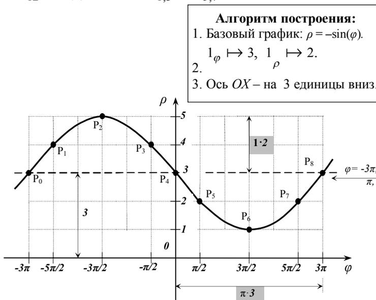
Рис.25а. График функции  $\rho = 3 - 2 \sin(\varphi/3)$  в системе координат  $(\varphi; \rho)$ .
