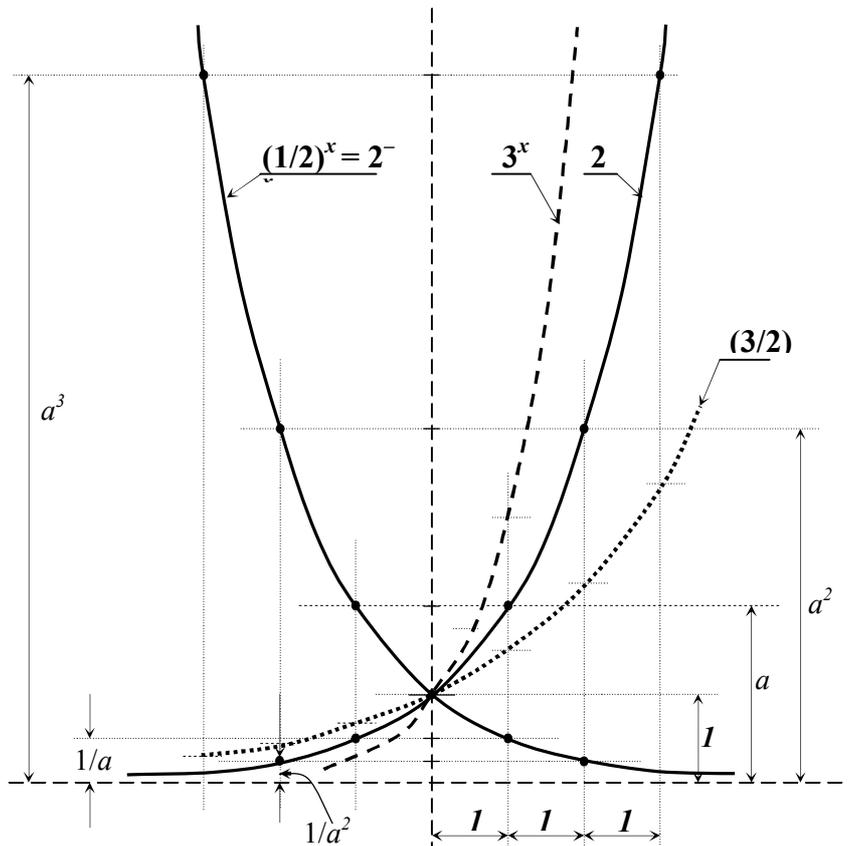
Рис.7а. Базовые графики показательной функции  $y = a^x$  для  $a = 3, 2, 3/2$  и  $1/2$ . Вертикальные линейные размеры привязаны к основанию  $a = 2$ .
