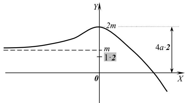
Рис.3б. Перемасштабирование оси  $OY$  при построении графика  $y=2f(x)$ ; базовый график  $y_0=f(x)$  – на рис.3а.
